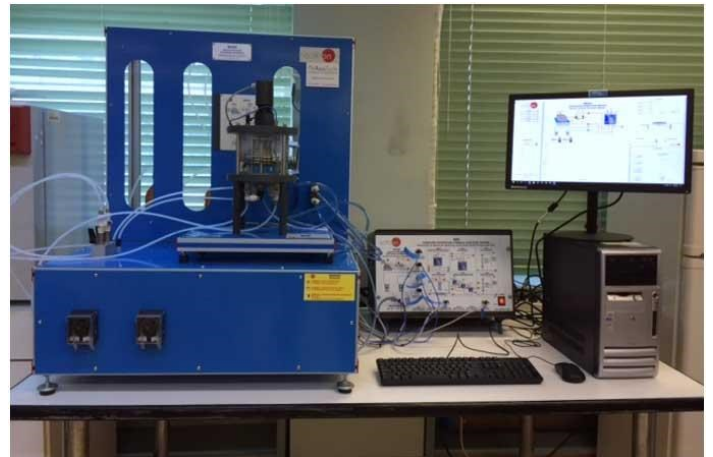
Νέα Διάταξη (εγκατάσταση 10/2/17) πλήρως ελεγχόμενου από ηλεκτρονικό υπολογιστή αντιδραστήρα τύπου CSTR στο Εργαστήριο Διεργασιών του Τμήματος.
